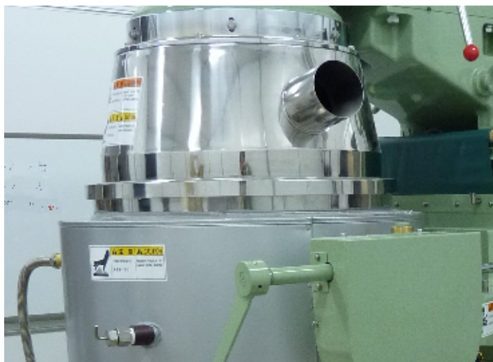
写真: 今回導入した2軸縦型加熱式混練機
